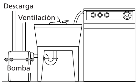
Figura 10 – Instalación típica en lavaderos y lavarropas
